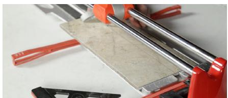
Placez le carreau marqué dans le coupe-carreau en alignant la ligne de coupe avec la molette de découpe. Poussez fermement le couteau le long de la ligne de coupe d'un seul mouvement continu. Assurez-vous que le pied du coupe-carreau se trouve près du bord du carreau et que la molette de découpe ne le touche pas. Appuyez sur la poignée de l'outil de façon à casser le carreau.
